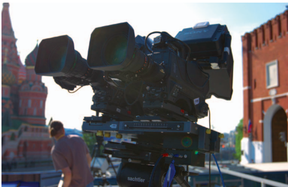
Горизонтальная платформа с параллельным расположением камер
